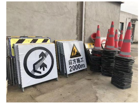
图 2.1.2 施工标志牌、锥桶
